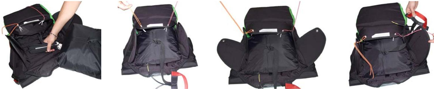
Führen Sie eine dünne Leine (Gleitschirmleine) in die Gummischlaufen, dann fädeln Sie die Ösen des Gurtzeug-Containers auf, beginnend mit den kleinsten, um diese unter Zug zusammenzuziehen. Folgen Sie dabei der Reihenfolge, die im Bild/Zeichnung ersichtlich ist.
